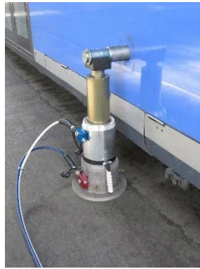
Abbildung 25: Hydraulischer Stufenheber mit Adapter für seitlichen Einsatz
