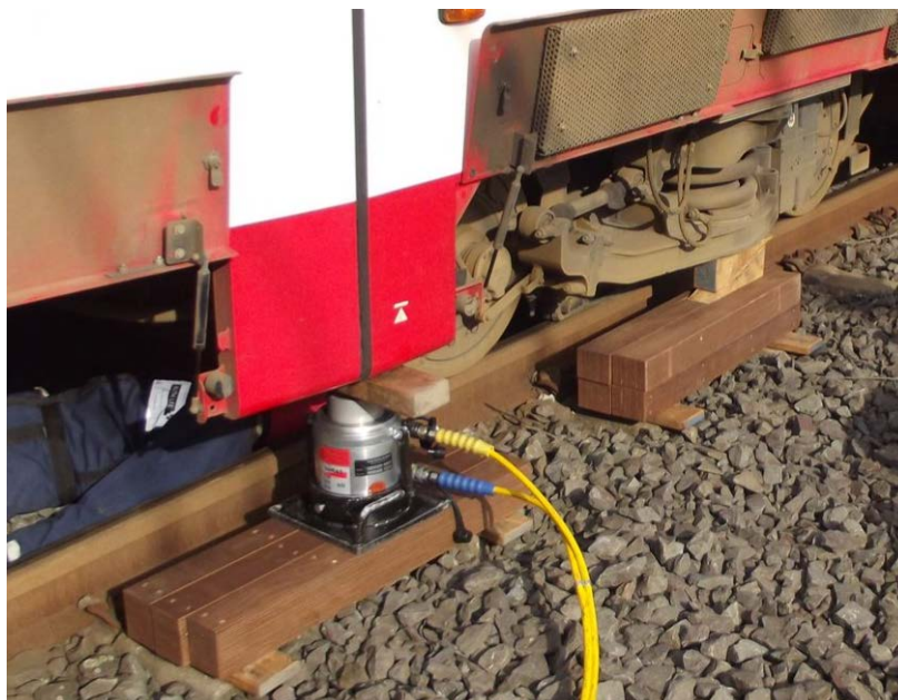
Abbildung 19: Unterbau und Hebesystem auf Schwellen aufgesetzt
