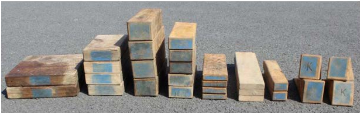
Abbildung 17: Rüstholz „Satz Straßenbahn“ eines Rüstwagens der Feuerwehr Dortmund
