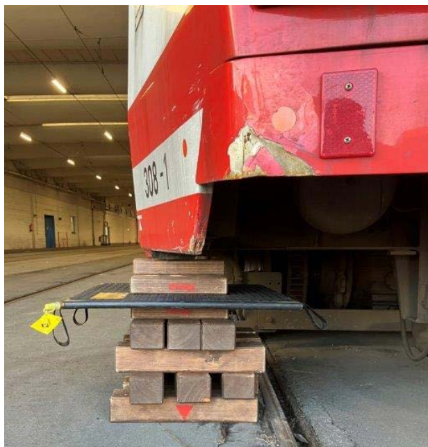
Abbildung 9: Hebekissen (8 bar) am Hebepunkt am Wagenkasten
