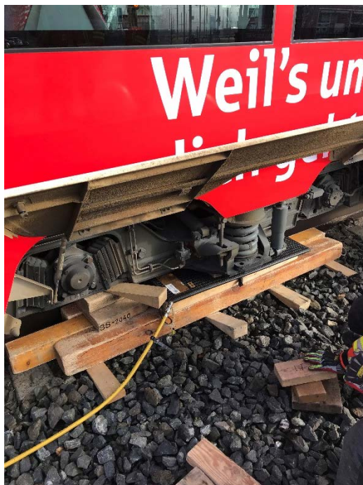
Abbildung 8 b: Hebekissen (8 bar) am Hebepunkt Drehgestell bei verschiedenen Untergründen
