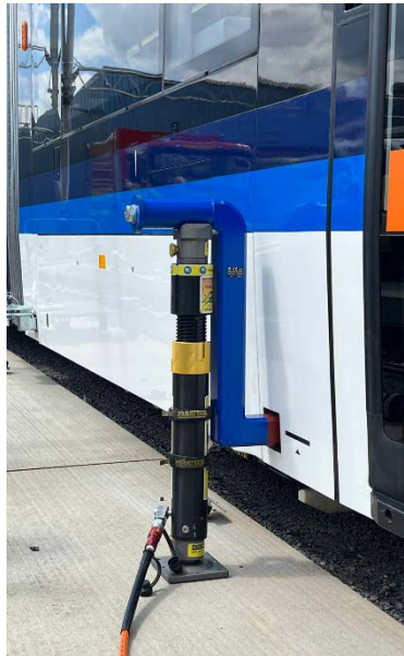
Abbildung 27: Zeigt Einschubpratze in Verwendung mit hydraulischer Rettungsstütze
