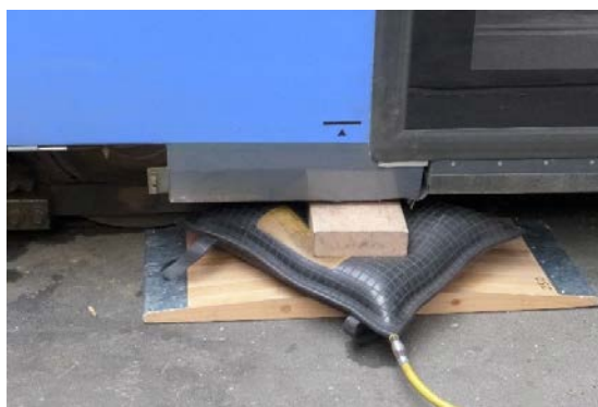
Abbildung 8 a: Hebekissen (8 bar) am Hebepunkt Drehgestell bei verschiedenen Untergründen
