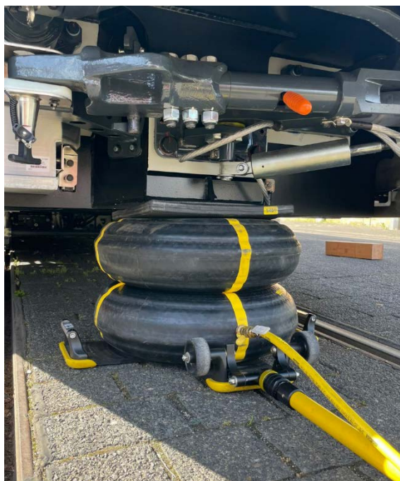
Abbildung 11: Hebekissen am Kopfhebeplatz mittig eingesetzt
