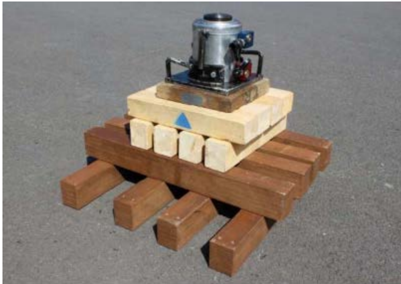
Abbildung 18: Hydraulischer Heber auf Rüstholz Unterbau Hart- und Weichholz in Kombination
