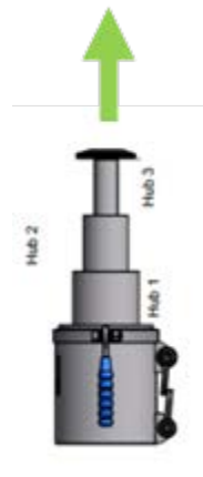
Abbildung 26: Wirkrichtung hydraulischer Stufenheber; Quelle Lukas Hydraulik
