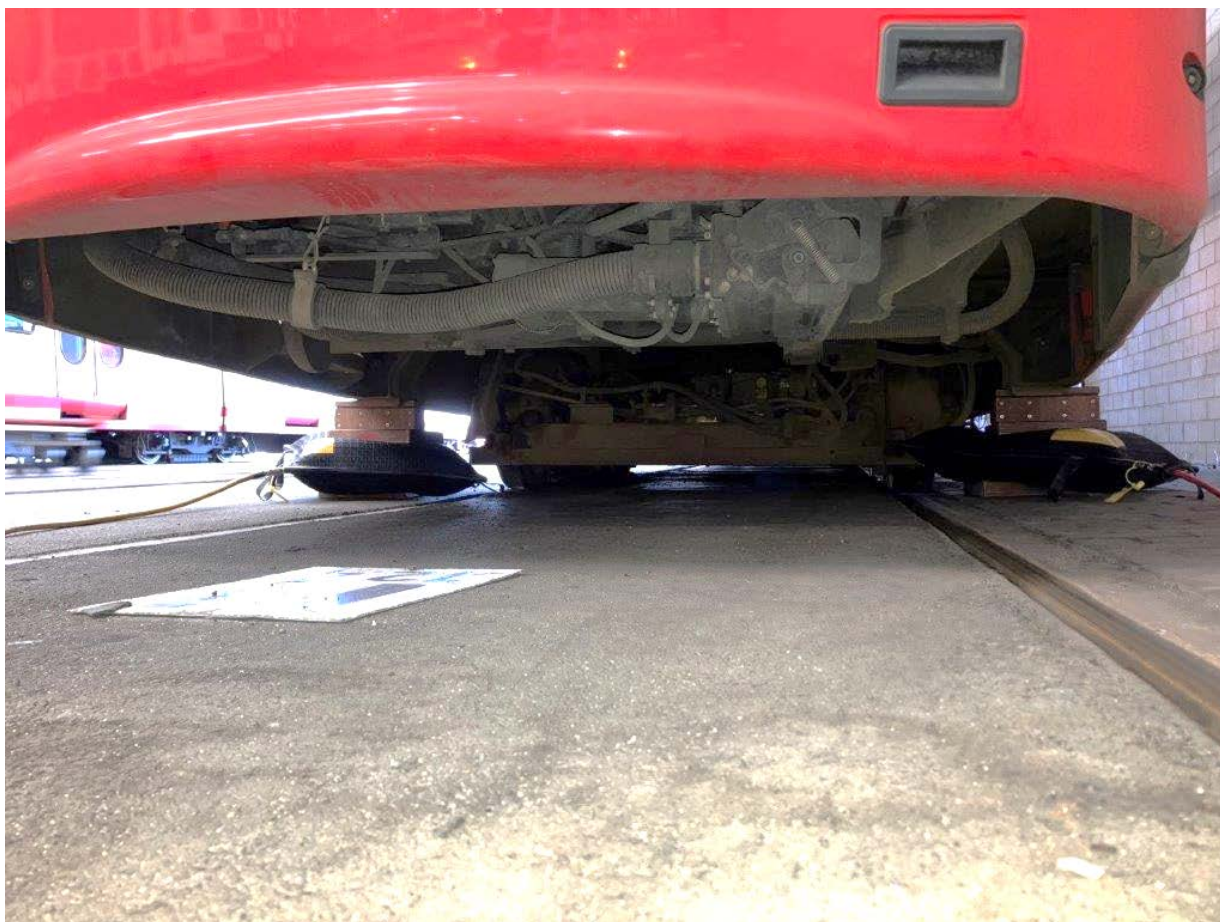
Abbildung 10: Hebekissen (8 bar) beim beidseitigen Hub (links und rechts) am Hebeplatz Wagenkasten
