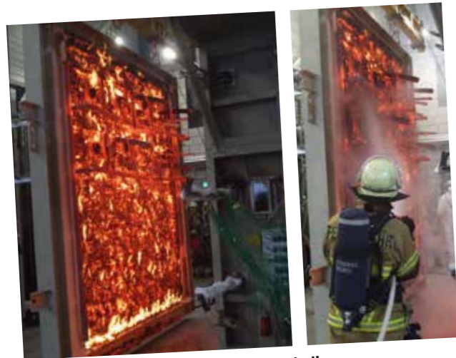
Löschen der Brettsperrholzwand durch die Berufsfeuerwehr Kaiserslautern.
