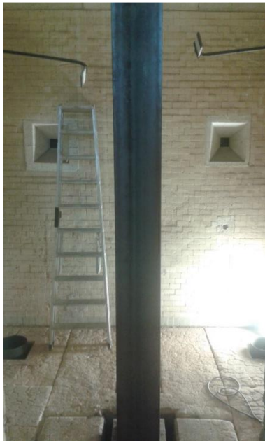
Bild 6.28 eingebaute Stütze im Versuchsofen (rechts) und statisches System (links)
