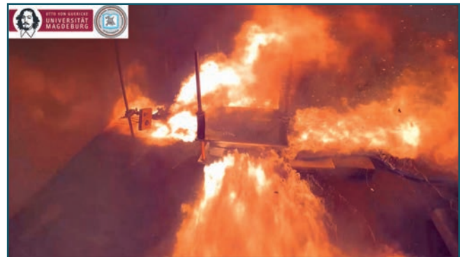
Bild 2: Versuche mit Lithium-Ionen-Batterien auf Zellebene: Erste Gase treten aus einer 75Ah-Pouch-Zelle bei einer Überladung auf (Abmessungen der Pouchzelle: 270 mm x 210 mm x 13 mm). Die Versuche sind eine Grundlage für das Projekt SEE-2L. Die Erkenntnisse werden später in Großversuchen überprüft. Bilder: S. Hahn
