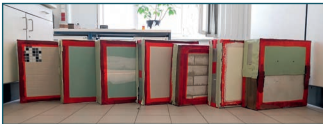
Bild 6: Probekörper für Vorversuche zum Durchgang von CO.
