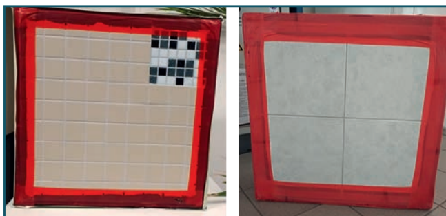
Bild 4: Wandprobekörper mit Fliesen (links: FL1; rechts: FL2).
