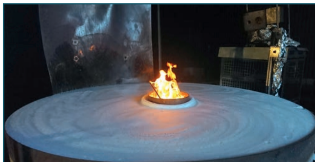
Bild 2: Mit Schaum gelöschter Flüssigkeitsbrand (4,5 m 2 ) mit Rückbrandgefäß.
