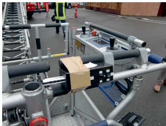
Abbildung 2: Dropped Units integriert in Feuerwehrfahrzeugtechnik; hier am Beispiel einer Drehleiter DLK 23-12.
