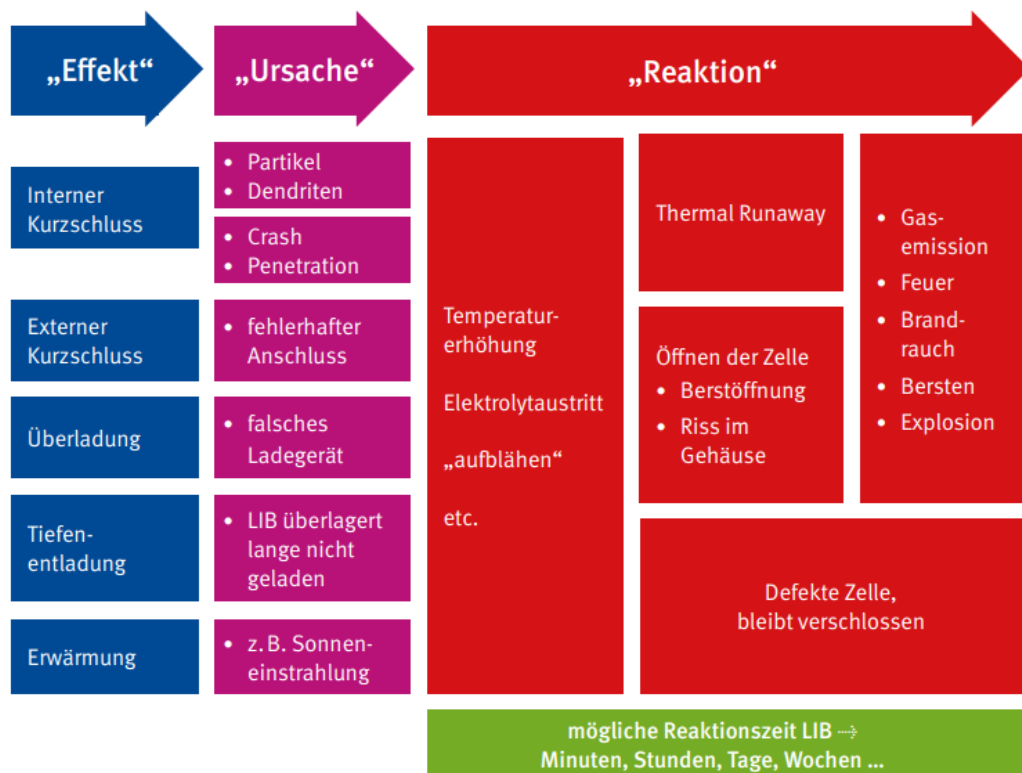
Abbildung 2: Einfluss von unterschiedlichen Ursachen auf die Gefährdungen und deren Reaktionen (Quelle: DGUV Information 205-041; „Thermal Runaway“ gleichzusetzen mit „thermisches Durchgehen“)
