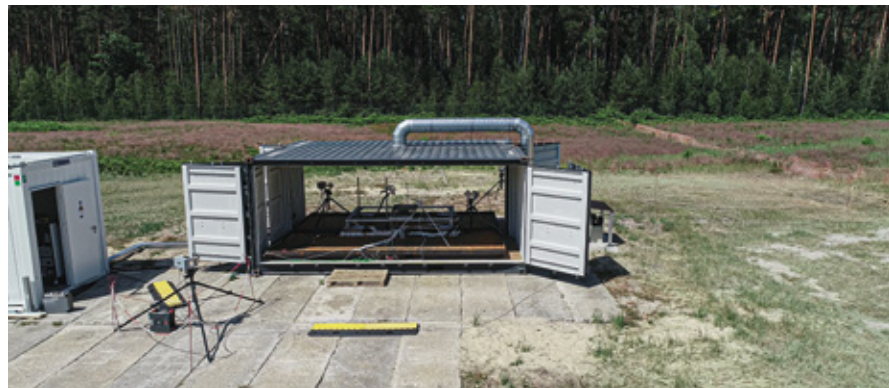
Versuchsstand zur Untersuchung der Auswirkungen beim thermischen Durchgehen von Lithium-Ionen-Batterien im Groß- und Realmaßstab
