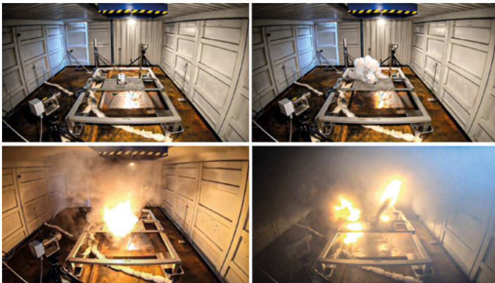
Thermisches Durchgehen eines Automobilantriebsmoduls in einem Vorversuch
