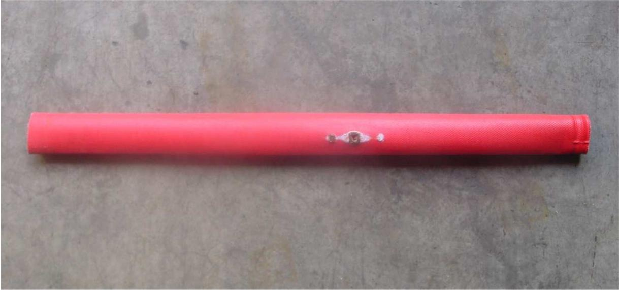
**Bild 13:** Schadensbild eines Klasse-2-Schlauches mit DLS in 275°C warmer Umgebung 6 Sekunden nach der Berührung mit einer 450°C warmen Platte (Vers.24)
