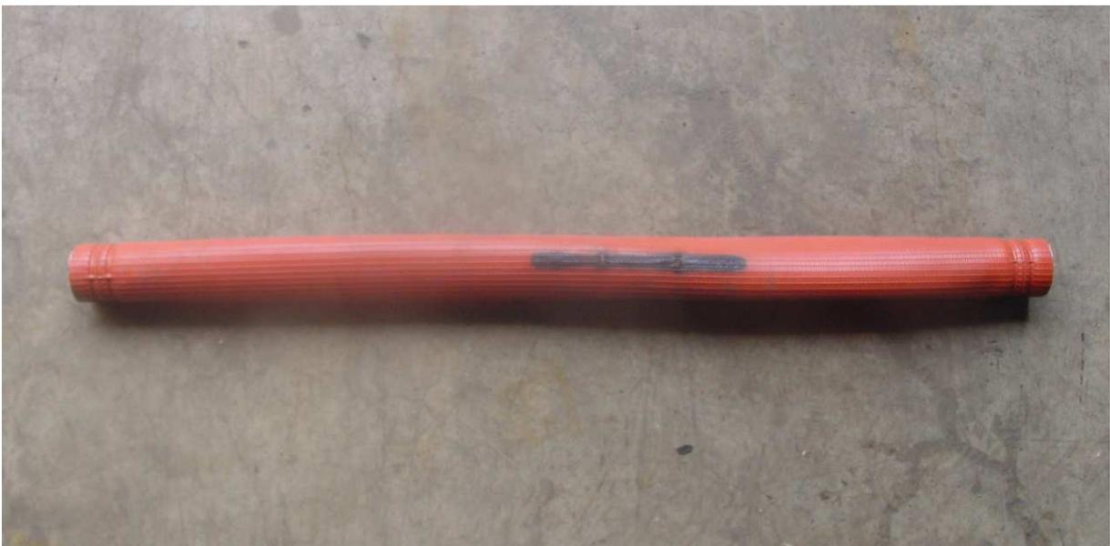
**Bild 14:** Schadensbild eines Klasse-3-Schlauches mit Wasser in 275°C warmer Umgebung 151 Minuten nach der Berührung mit einer 450°C warmen Platte (Vers.48)
