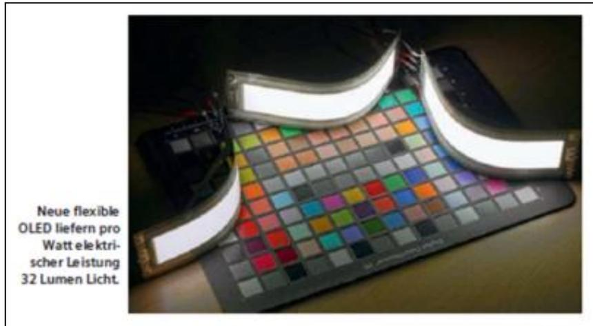
Abbildung 28 OLED als biegsame Struktur
