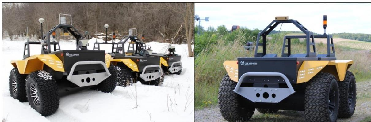
Abbildung 43 Autonomer, geländegängiger Transporter Grizzly
