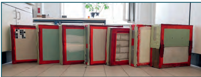
Bild 6: Probekörper für Vorversuche zum Durchgang von CO.
