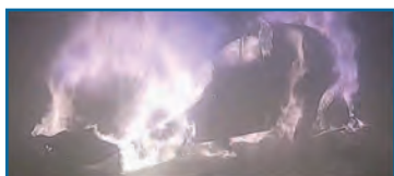
Bild 3: Fahrzeug im Vollbrand nach Penetration des Batteriesystems mit einem Metalldorn.
