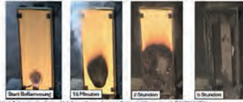
Abb. 3: Schwelverlauf einer Holzfaserdämmplatte im Schwelgroßbrand nach DIN EN 16732
