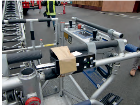
Abbildung 2: Dropped Units integriert in Feuerwehrfahrzeugtechnik; hier am Beispiel einer Drehleiter DLK 23-12.
