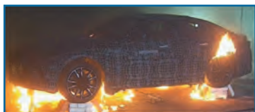
Bild 2: Fahrzeug in der Brandentstehungsphase nach Penetration des Batteriesystems mit einem Metalldorn.
