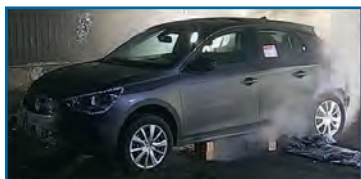
Bild 1: Austritt von Ventinggasen nach Penetration des Batteriesystems mit einem Metalldorn.
