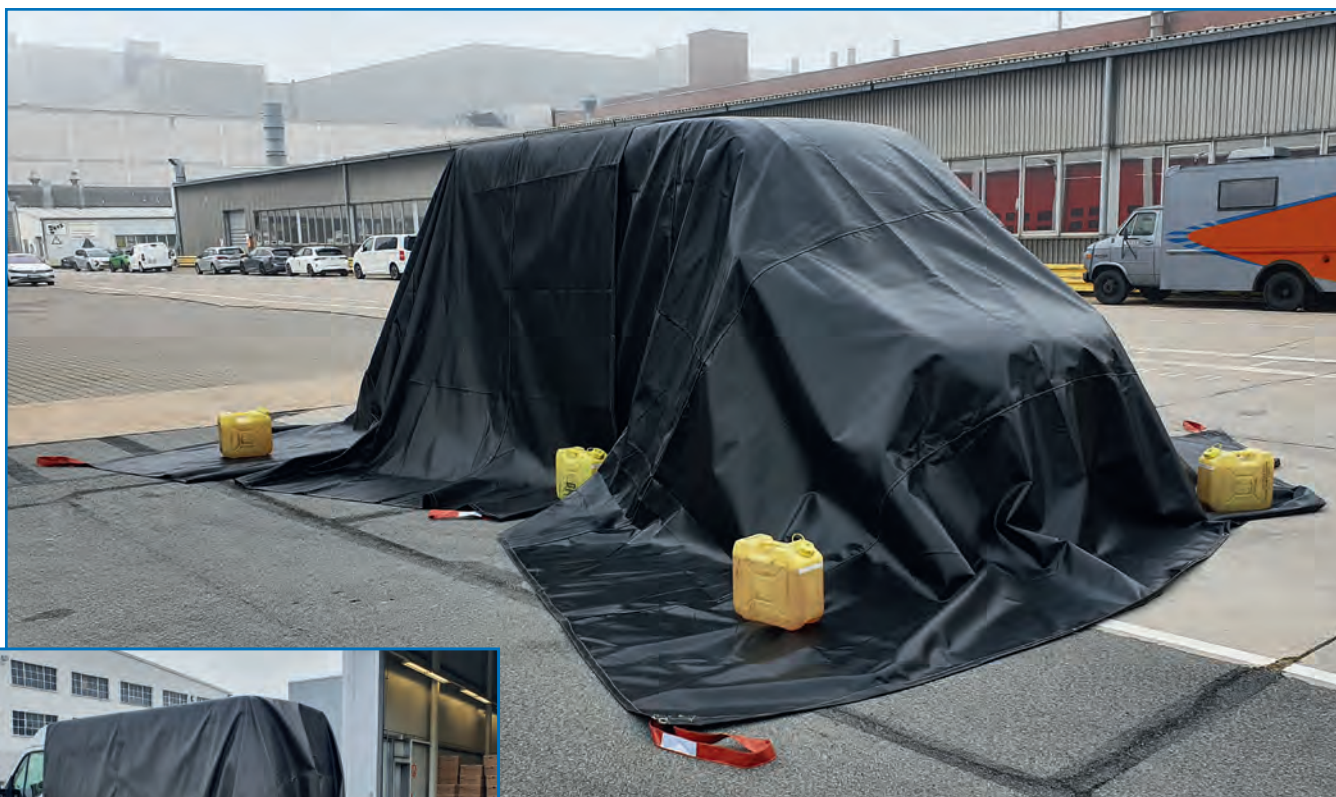
Abbildung 5 und 6: Mögliche Anwendung von Brandbegrenzungsdecken zur Sicherung von Fahrzeugen. Brandbegrenzungsdecken für Elektrofahrzeuge können die Brandausbreitung auf benachbarte Objekte behindern, z. B. auf Quarantäneplätzen bei Abschleppunternehmen. Normative Anforderungen sind aktuell in Bearbeitung bzw. Erstellung. Der Einsatz bei der Brandbekämpfung wurde im Rahmen eines Forschungsprojekts untersucht.
