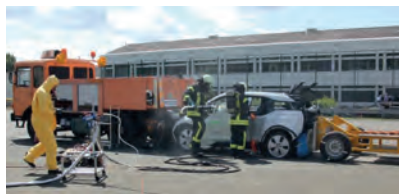
Crash-Test BMW i3 bei der BAST mit der Feuerwehr Köln und einem mobilen Gasanalytik-System des Fraunhofer ICT.
