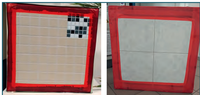
Bild 4: Wandprobekörper mit Fliesen (links: FL1; rechts: FL2).
