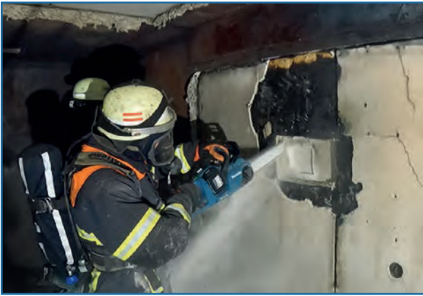
Abbildung 4: Öffnung des Bauteils zur Entnahme des lokalisierten Hohlraumbrandes im Brandcontainer.
