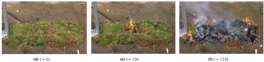
Abb. 4: Brandversuch 1, Flammenbrand bereits nach 4 Sekunden, Versuchsende nach 02:12 Min. [6]
