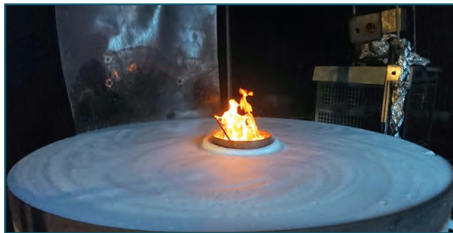
Bild 2: Mit Schaum gelöschter Flüssigkeitsbrand (4,5 m 2 ) mit Rückbrandgefäß.
