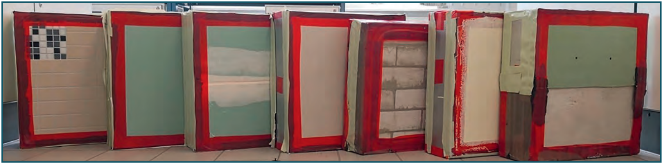
Bild 2: Beispielhaft einige der hergestellten, noch nicht isolierten Wandprobekörper (von links nach rechts: Fliese FL; Gipskarton GK; Holztafelwand H; Polystyrol­dämmung PS; Mauerwerk; Wandfarbe W; Gleitender Deckenanschluss Y).
