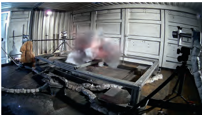
Neuer Großversuchsstand im Projekt SEE-2L auf dem Testgelände der Bundesanstalt für Materialforschung und -prüfung in Betrieb genommen; getestet wurden zunächst Module bis 7 kWh:
