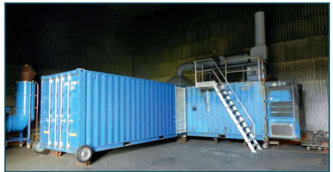
Bild 4: Versuchseinrichtung zur gezielten Exposition von Schutzkleidung im Technikumsmaßstab.
