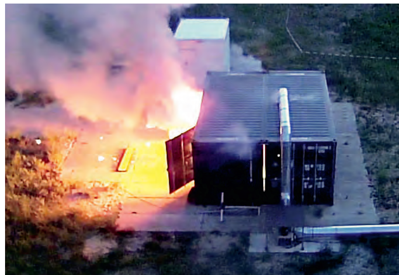
Neuer Großversuchsstand im Projekt SEE-2L auf dem Testgelände der Bundesanstalt für Materialforschung und -prüfung in Betrieb genommen; getestet wurden zunächst Module bis 7 kWh:
