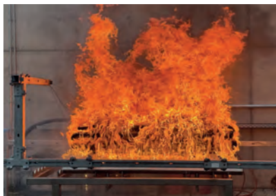
UN GTR13 Test eines drucklosen Wasserstofftanks am Fraunhofer ICT.
