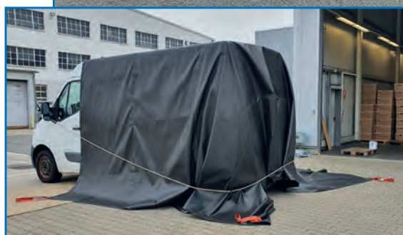
Abbildung 5 und 6: Mögliche Anwendung von Brandbegrenzungsdecken zur Sicherung von Fahrzeugen. Brandbegrenzungsdecken für Elektrofahrzeuge können die Brandausbreitung auf benachbarte Objekte behindern, z. B. auf Quarantäneplätzen bei Abschleppunternehmen. Normative Anforderungen sind aktuell in Bearbeitung bzw. Erstellung. Der Einsatz bei der Brandbekämpfung wurde im Rahmen eines Forschungsprojekts untersucht.
