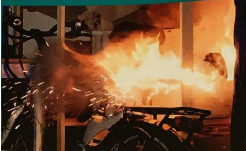
Bild 3 | Explosion eines E-Bike-Akkus (Quelle: IFS Report, 22. Jahrgang, März 2019)
