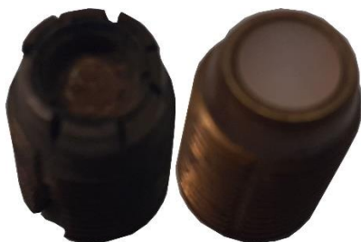
Abbildung 17 Defekter Ventilsitz (Druckbehälter)
